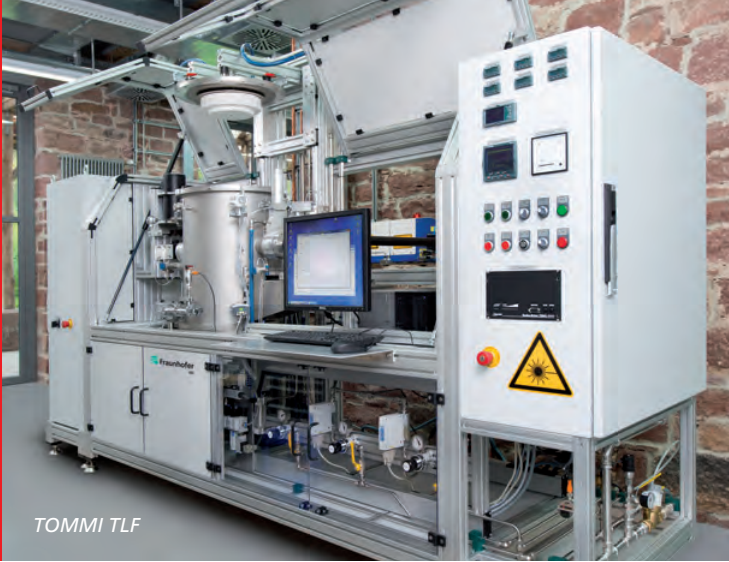
Thermischer Prozess von Braunkohle- restschlacke bei 1100 °C
