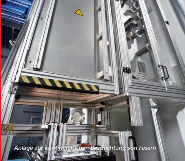
Beschichtung von textilen Halbzeugen mit Polymeren
