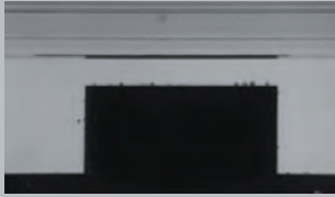
Bild 2 b: Konturbild der Probe während des Versuchs. Es ist eine Blasenbildung an der Oberfläche zu erkennen.
